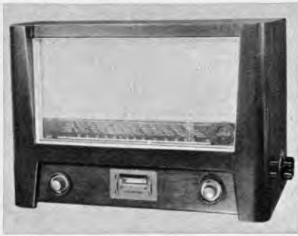
Links: Bild 2. Im Frühjahr 1949 entwickelte Telefunken diesen Prüfeempfänger mit Mittel- und Ultrakurzwellenbereich. In Schalterstellung UKW arbeiteten eine RV 12 P 2001 als Hf-Vorstufe, eine weitere als Oszillator, drei EF 14 als Mischer bzw. Zf-Stufen (10,7 MHz). Der Ratiodektor war mit einer Duodiode EB 11 bestückt; in dem Niederfrequenzverstärker steckten die Röhren EF 12 und EL 12
