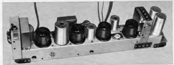
Bild 3. Im Jahre 1950 wurden viele AM-Empfänger mit Hilfe von UKW-Einbauteilen umgerüstet. Unser Bild zeigt das Einbauteil UKW 4 C von Telefunken, bestückt mit den Stahlröhren ECH 11 (Osz./Mischer), 2 x EF 14 (Zf) und EAA 11 (Ratiodektor). Dieses Chassis wurde auch als UKW-Vorsatz unter der Bezeichnung UKW 5 B geliefert. Die Abstimmung erfolgte mit einem Doppelschiebevariometer mit kombinierten Hf-Eisen- und Al-Kernen
