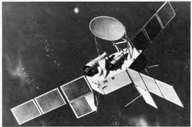
Bild 2. Entwurfsskizze vom Nachrichtensatelliten „Symphonie“. Im Zentrum der sechseckige Behälter mit den nachrichtentechnischen und sonstigen Einrichtungen, oben drei Antennen und Schubvorrichtungen und an drei Kanten die ausgeklappten Träger mit 22 000 Solarzellen
