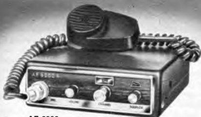
AF 6000 Exclusives Gerät höchster Qualität mit besonders geringen Abmessungen. 18 Transistoren, 6 Kanäle, Schutzschaltung gegen Übermodulation, Empfängerteil hochempfindlicher Doppelsuper mit mechanischem Filter, 2 W Input (deutsche Bestimmungen), 5 W Export.
