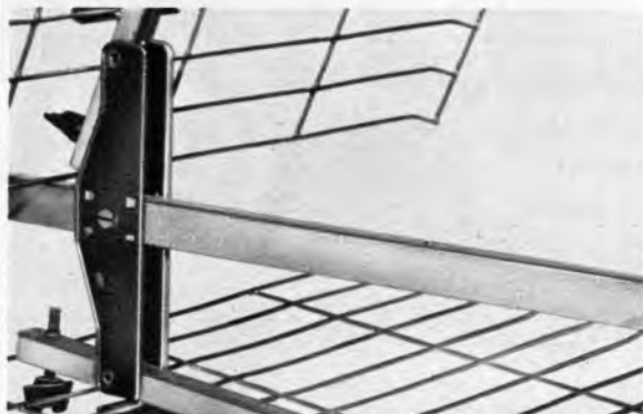
2. Reflektorhälften hochklappen und mit Flügelschrauben festziehen.
