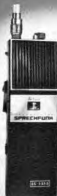
BS 555 G Außerordentlich robustes und leistungsstarkes Handfunksprechgerät für universellen Einsatz. 15 Transistoren, 3 Kanäle, eingebauter selektiver Licht/Ton-Ruf, Antenne nur 54 cm lang, abschraubbar, 2 W Input (deutsche Bestimmungen).
